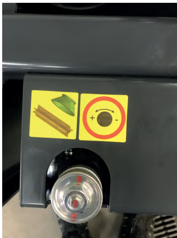
Regulátor otáček hlavního a bočního kartáče
