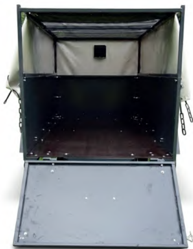
Maße des Kastenaufsatzes Länge: 1500mm Breite: 900mm Höhe: 400mm
