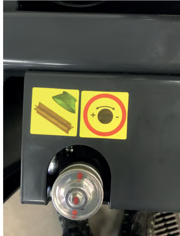
Geschwindigkeitsregler für Haupt- und Seitenbesen
