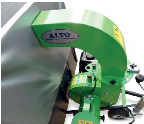
Manuell verstellbarer und drehbarer Auswurfkanal
