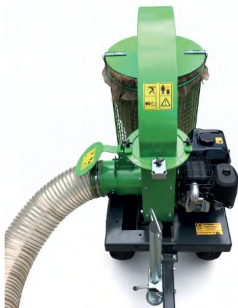
Helposti irrotettava poistokanava puhdistusta varten
