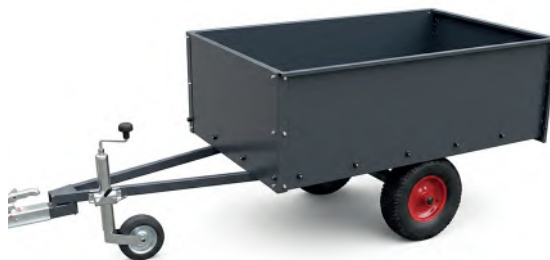
Lavan sisämitat Pituus: 1500mm Leveys: 900mm Korkeus: 500mm
