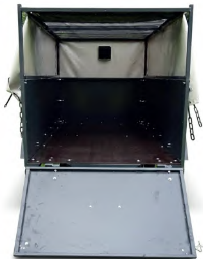
Lavan korotuksen mitat Pituus: 1500mm Leveys: 900mm Korkeus: 400mm
