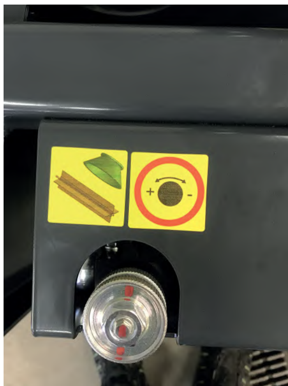
Pagrindinio ir šoninio šepčio sūkių reguliatorius
