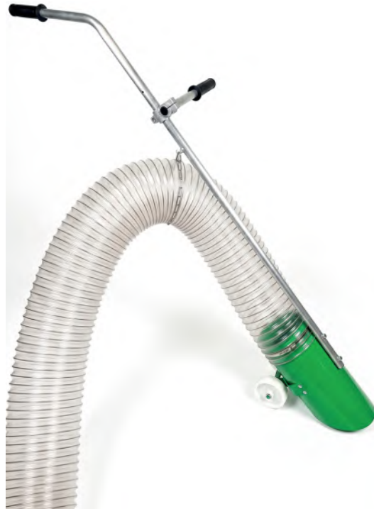
Nodilumizturīga caurspīdīga šļūtene un viegls rokas uzgalis. Caurspīdīgā šļūtene ļauj vizuāli kontrolēt un ātri novērst aizsprostojumus.
