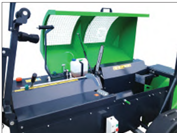
Automatické mazání pily. Množství oleje na řetěz je nastavitelné.
