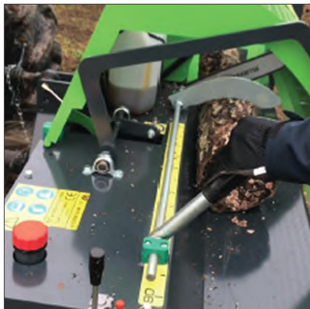
Modely ALTO KSK-50 mají 13palcovou vodící lištu a standardní řetěz. Max. průměr řezu 30 cm, max. délka špalku 50 cm.
