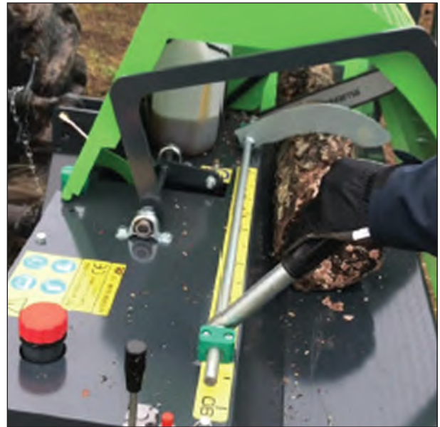
ALTO KSK-50 Modelle haben ein 13-Zoll-Schwert und eine Standard-Sägekette. Max. Schnittdurchmesser 30 cm, max. Scheitlänge 50 cm.
