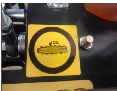
Einstellschraube für die Kettenölmenge.
