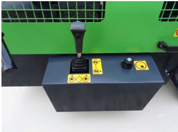
Joystick steuert Schwert und Zuführband. Zusätzlich Schwertvorschub per Handschraube rechts regelbar.
