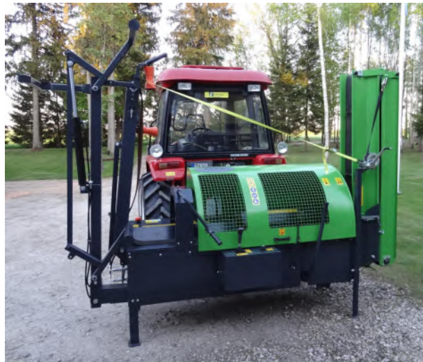
Für Dreipunkt-Geräte wählbar: Gelenkwellenantrieb, Elektromotor oder beides.
