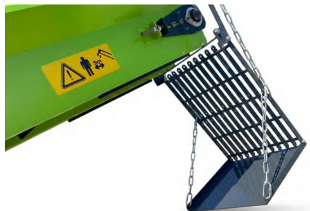
Fang- und Leitblech für Späne und Sägemehl.
