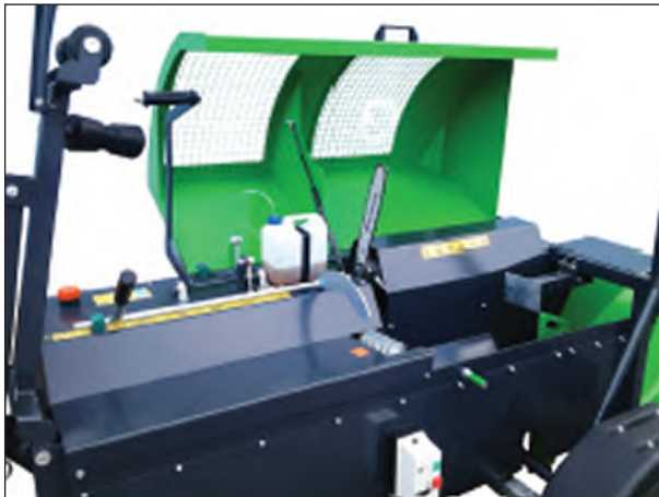
Automatische Sägekettenschmierung. Die Kettenölmenge ist einstellbar.
