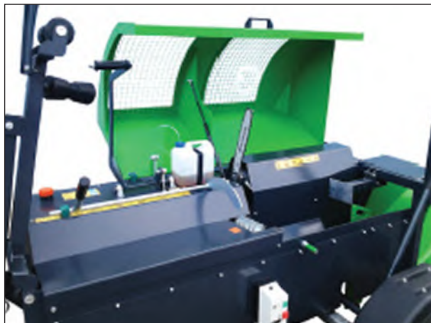
Sahaketjun voitelu on automaattinen. Ketjuöljyn määrä on säädettävä.
