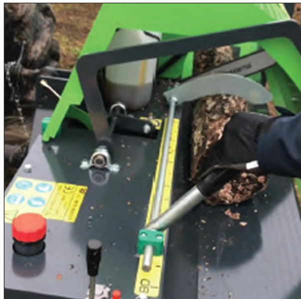
ALTO KSK-50 -malleissa on 13 tuuman ohjauskisko ja vakiosahaketju. Sahattavan puun max. läpimitta 30 cm, pölkyn max. pituus 50 cm.
