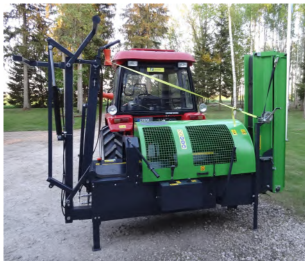
Trijų taškų kabinimo įrenginiui – kardaninė pavara, elektros variklis arba abu.
