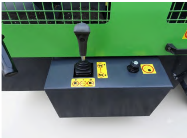
Joystick steruje prowadnicą i przenośnikiem podającym. Posuw prowadnicy reguluje śruba ręczna po prawej.
