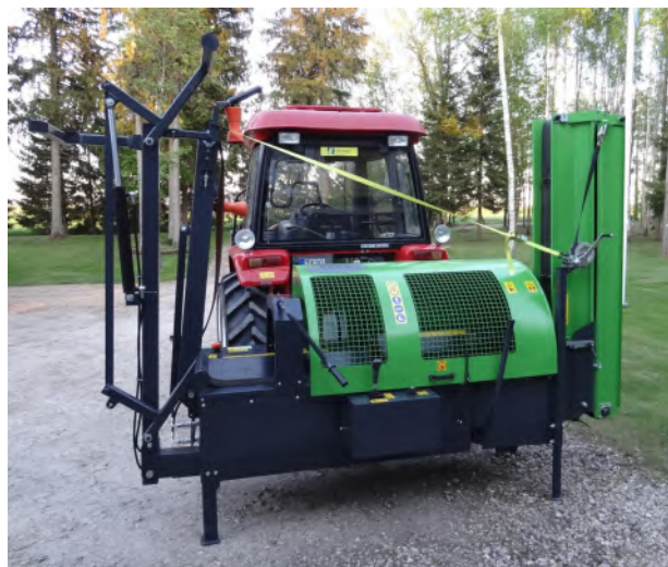
Do wersji na TUZ można wybrać napęd wałem, silnik elektryczny lub oba.
